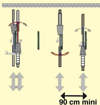
**4/ alterner le sens d'introduction des roues avant** dans le râtelier (soit 0,66 m<sup>2</sup> par vélo).
