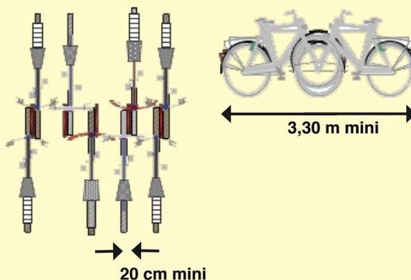
En outre, un vélo a besoin à l'arrière d'une zone de dégagement d'environ 1,80 m pour pouvoir être introduit dans l'emplacement ou sorti.
